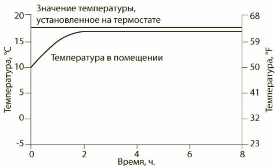
Рис. 18. При включенном обогревателе температура в помещении повышается до заданного значения и поддерживается на этом уровне, несмотря на утечки тепла
