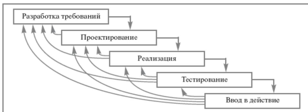
**Рис. 2.2.** Поэтапная модель с промежуточным контролем
