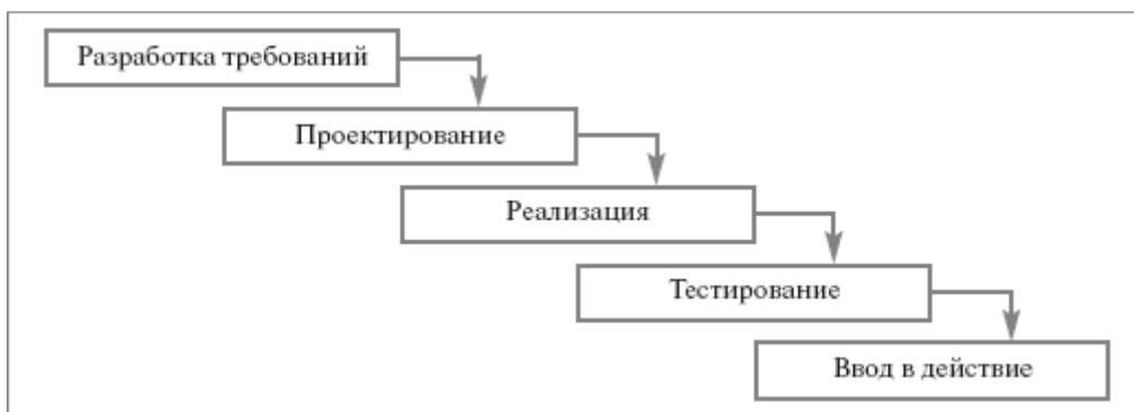
**Рис. 2.1.** Каскадная модель ЖЦ ИС
